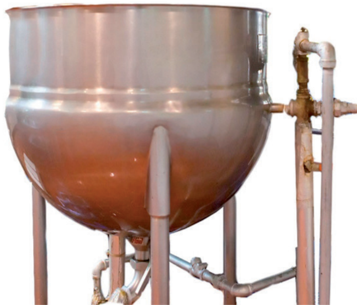
Figura 7.14 Equipo de concentración discontinuo (marmita)
