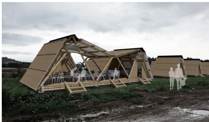
Figura 54: Unión de módulos para crear zonas comunitarias.
