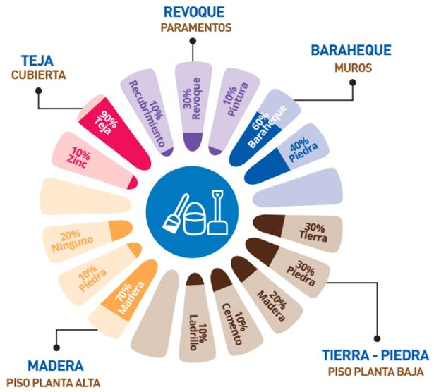
En Javier Loyola se evidencia edificaciones construidas especialmente con muros de bahareque; pisos de piedra, tierra y madera; cubiertas de teja; paramentos de revoque y tanto puertas como ventanas de madera.
