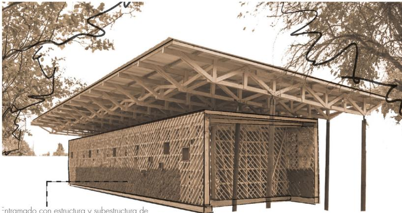
Entramado con estructura y subestructura de madera que recibe el revoco de barro con fibras
