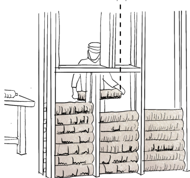
Fig. 2.3.2 | Carretes de paja con barro. | Fuente: Autoría Propia. (2024).
