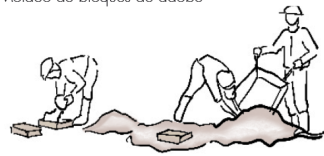
4. Secado de bloques de adobe
