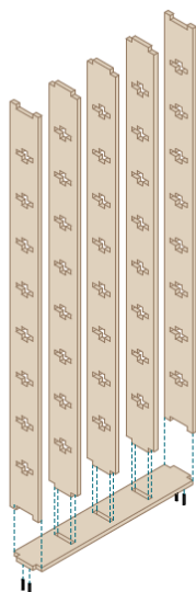
Paso 1 Tablón inferior, tableros laterales y verticales.
