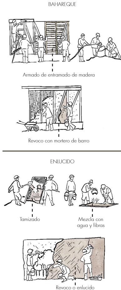
Fig. 2.3.5 | Construcción de tabiques con bahareque. | Fuente: Autoría Propia. (2024).
