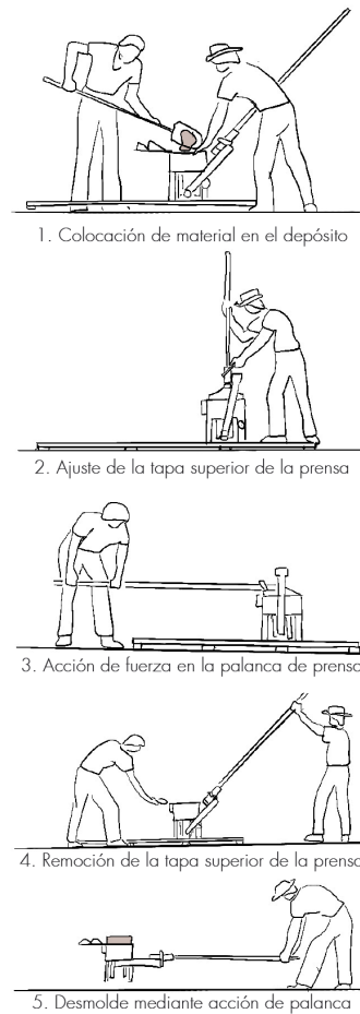
Fig. 3.2.7 | Proceso de prensado mediante máquina CINVA RAM. | Fuente: Autoría Propia (2024).
