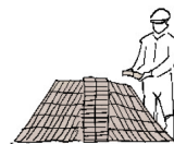
Fig. 2.2.1 | Construcción de tabiques con adobe. | Fuente: Autoría Propia. (2024).
