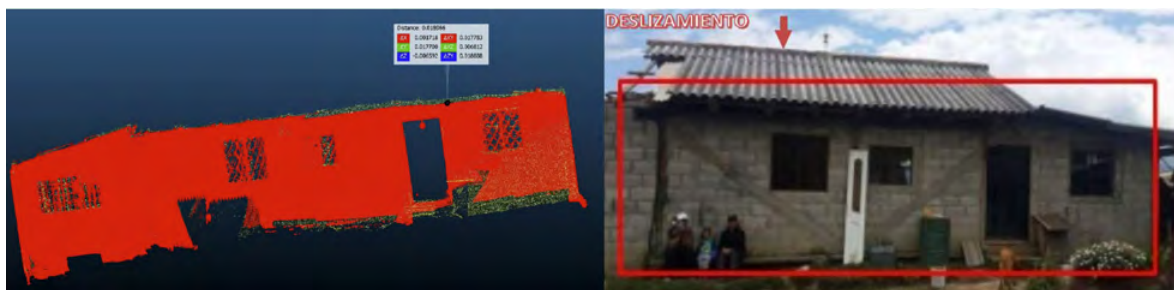
Figura 4: (Izquierda) Pared cercana al deslizamiento, en rojo: escaneo de mayo y en amarillo: escaneo de junio, (derecha) pared en campo.
