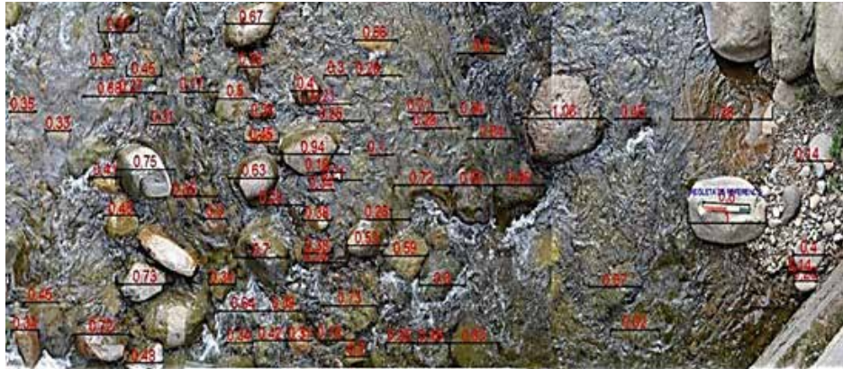
Imagen 1.2. Medición del tamaño de las piedras
